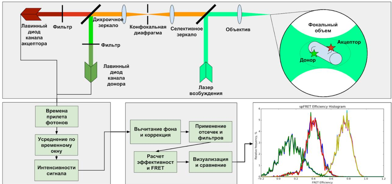
Рисунок 4. Схема эксперимента spFRET. Флуоресценция возбуждается аргоновым лазером на длине волны 514 нм и собирается из конфокального объема на лавинных фотодиодах. Полученные времена прилета фотонов интегрируются по времени программным обеспечением микроскопа. Затем данные обрабатываются и выводятся для последующего анализа.
